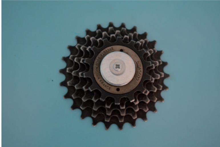
La **roue libre** est une petite roue avec des dents placée au milieu de la roue arrière.
