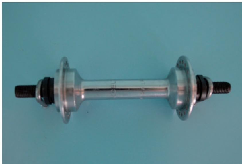
Le **moyeu** est un petit tube situé au milieu des roues.
